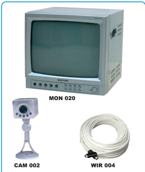
Kit de vigilancia B/N, compuesto de cámara, monitor de 14" con procesador de CUAD, alarmas, cuatro canales de entrada de video y conexión cámara monitor de 20m.
