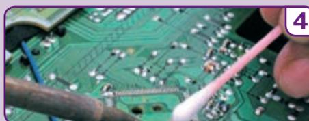
**4** Limpiar el CHIP QUICK con un desoldador (HK 474) ó manualmente con un bastoncillo, rematar la operación con un limpiador de placas, KONTAKT PCC (AER 057), alcohol, etc.
