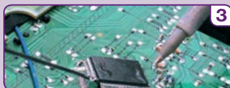
**3** Repasar todos los lados del C.I. con el soldador hasta observar que el CHIP QUICK está en estado líquido, quitar el circuito con la ayuda de un extractor.
