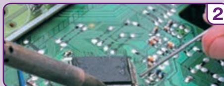
**2** Con un desoldador a baja temperatura, depositar el CHIP QUICK cortocircuitando todos los pines del circuito.
