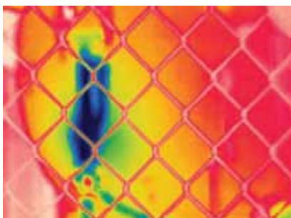
Los sistemas pasivos de autofocus a menudo solo capturan los sujetos en primer plano; en este caso el eslabón de la cadena
