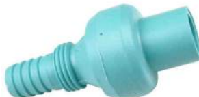
C-6012 Válvula anti-retorno Para todas las bombas de inmersión. La conexión directa a la salida de la bomba evita la presión de retorno. Para mangueras de Ø10 mm. Medidas: Longitud 50 mm Ø27 max.
