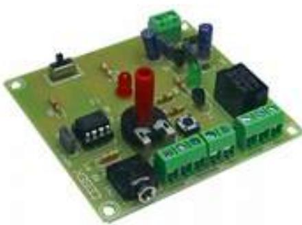
Picaxe intègre 08 micro M2. Entrée numérique avec fonction de réglage push-pot commutateur, le relais de sortie 3 ampères, indicateurs de puissance et le connecteur de relais d'enregistrement approprié pour le développement de l'automatisation nécessitant un contrôle externe avec un bouton et un potentiomètre, par exemple une minuterie.
