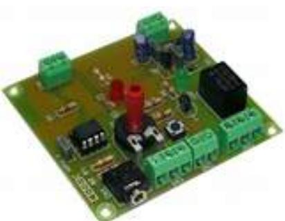
Picaxe intègre 08 micro M2, entrée LDR / NTC y compris entrée numérique avec réglage de poussée pot, le relais de sortie 3 ampères, les indicateurs LED pour la puissance et le relais d'enregistrement de connecteur. Idéal pour le développement des commandes d'éclairage et analogique nécessitant potentiomètre ou programme de réglage de la température.
