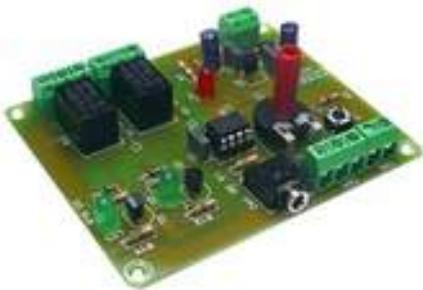
Picaxe intègre 08 micro M2. Entrée numérique avec le pot de réglage de bouton-poussoir, relais 2 de sortie 3 ampères, nous fournissons des indicateurs et des relais, enregistrement connecteur.
