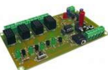
Intègre 08 micro Picaxe M2, le bouton d'entrée sélectionnable ou jeu de pot, 4 sorties relais 3 ampères, des indicateurs et des relais électriques, enregistrement connecteur.
