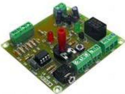
Picaxe intègre 08 micro M2. Tension d'entrée diviseur de 50, 20 et 10V enregistrement connecteur.
