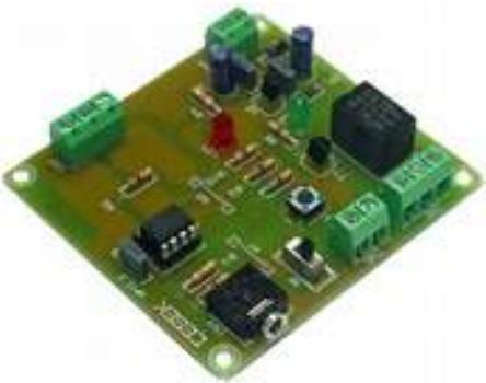
Intègre 08 micro Picaxe M2. 18B20 y compris la sonde d'entrée, entrée numérique avec un bouton-poussoir, la sortie relais de 3 ampères, les indicateurs LED pour la puissance et le connecteur de relais adapté pour enregistrer la température et le développement des thermostats de précision avec sonde numérique 18B20.
