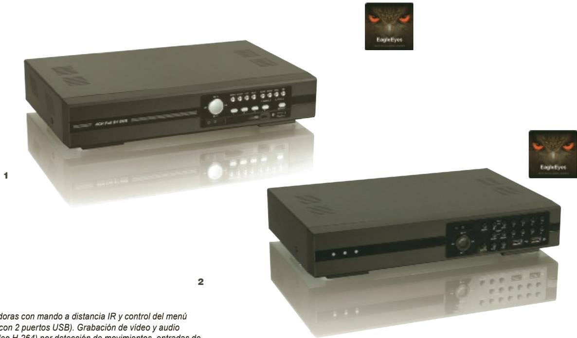
DVR o videograbadoras con mando a distancia IR y control del menú por un ratón USB (con 2 puertos USB). Grabación de vídeo y audio (compresión de vídeo H.264) por detección de movimientos, entradas de alarma, control manual y por temporizador. Es posible copiar imágenes del disco duro con USB y red. Salida de vídeo HD por la salida VGA. Control de cámaras PTZ por RS-485. Es posible la videovigilancia a distancia por PC o smartphone. El disco duro no está incluido.
